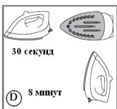
Функция автоматического выключения утюга действует следующим образом:
