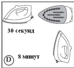
Funcția de oprire automată a fierului de călcat funcționează după cum urmează: Fierul de călcat lăsat pe talpă sau răsturnat lateral, care s-a încălzit până la o anumită temperatură, dar nu este folosit, se va opri automat după 30 de secunde. Dacă fierul de călcat nu este utilizat și se află pe suport în poziție verticală, modul de oprire automată va funcționa după 8 minute (fig. D). Oprirea automată a fierului de călcat este însoțită de un semnal sonor.
