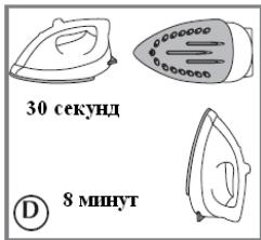
Үтікті автоматты сөндіру функциясы келесідей тәсілмен жүзеге асады: Белгілі бір температураға дейін қыздырылған, бірақ, қолданылмаған үтік, сондай-ақ, табанында жатқан немесе бір қырынан жатқан үтік 30 секундтан кейін автоматты тұрде сөнеді. Егер үтік пайдаланылмаса және таяныштірекti тігінен тұрса, - автоматты тұrde сөну режимі 8 минуттан кейін қосылады ( D сурет). Үтік автоматты тұrde өшкен кезде дыбыстық сигнал естіледі.
